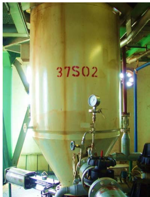
Slika 4. FUNDA filter koji se koristi na postrojenju Bijeljenja baznih ulja a) gornji dio filtera sa centralnom osovinom b) kućište filtera
