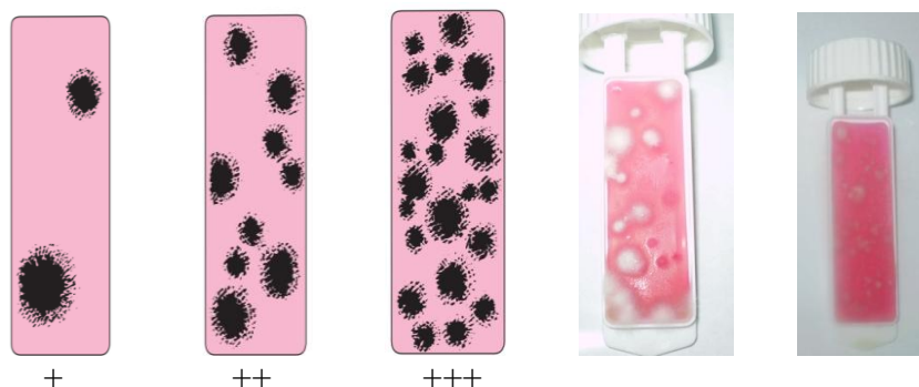
Slika 2. Etalon Roze – bengalskog agra za određivanje plijesnji u emulziji i fotografija pločica prije i posle tretiranja sa fungicidom uzorka vodenog rastvora iz Sistema 2.
